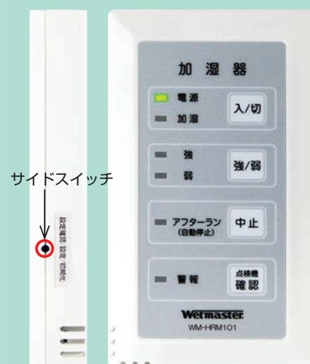
②で点灯していた表示灯が消灯し、「加湿」表示灯、「警報」表示灯が点灯します。
