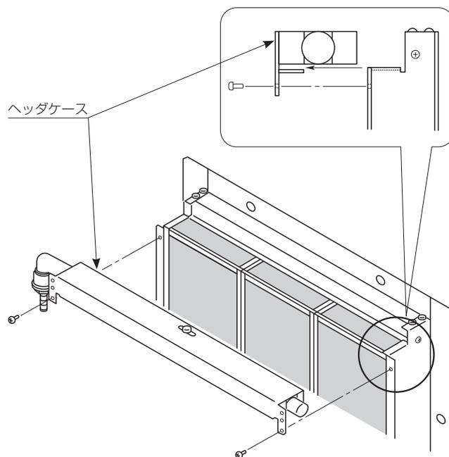
⑦②で外した、ヘッダ固定ステーに付いているヘッダ固定金具を反対に組み替えてください。【図-7】
