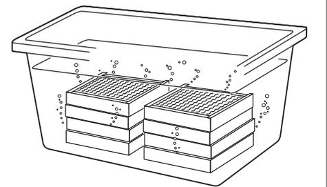
10) 漬け置きしたら加湿モジュールを取り出して十分に水洗いをしてください。その後、静置して水気を落とし、乾燥させます。
